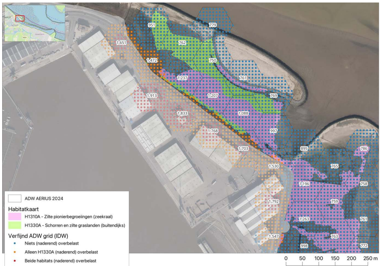
Afbeelding 10 Interpolatie van de in AERIUS 2024 berekende ADW in een grid met een resolutie van 10 meter.
