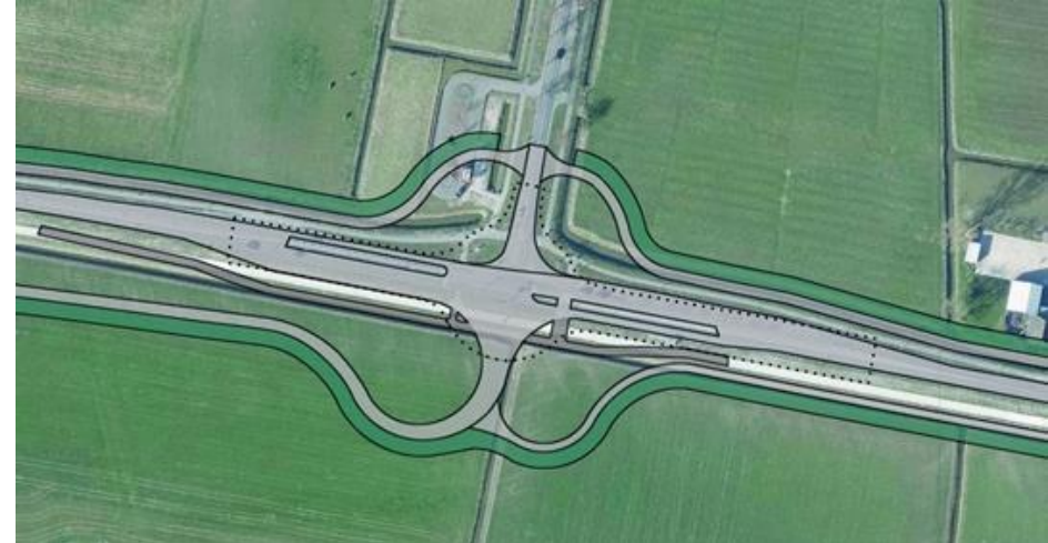
Uitgewerkte schets voorrangskruispunt met verkeerslichten
