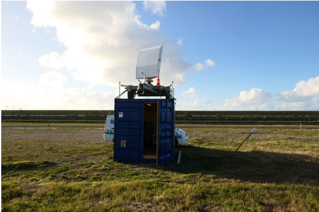
Figuur 2.1 3D-vogelradar MAX®. Het weerstation dat aan het radarsysteem is gekoppeld is hier bevestigd op de pylon.
