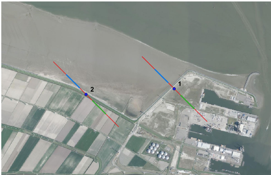
Figuur 2.4 Locaties die gebruikt zijn voor het onderzoek met de Furuno scheepsradars in de Eemshaven in het najaar van 2018 en het voorjaar van 2019. De rode balk geeft het totale bereik van de verticale radarbundel weer (in werkelijkheid is de radarbundel breder dan de weergegeven smalle lijn; het betreft een uitlopende waaier vanaf de radar). De blauwe en groene streken representeren vakken 2 en 4, waarvan de gegevens in de analyse zijn gebruikt (zie § 2.3.5 en Figuur 2.5).
