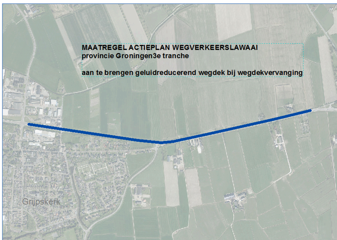
Afbeelding 8: aanduiding traject voor aanleg geluidreducerend asfalt ingevolge dit actieplan
